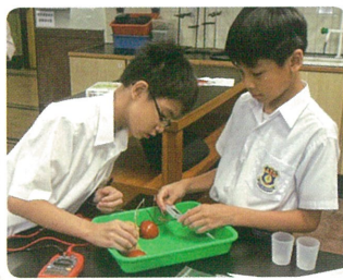
生果時鐘：學生比較不同生果輸出的電流，嘗試驅動電子鐘。
